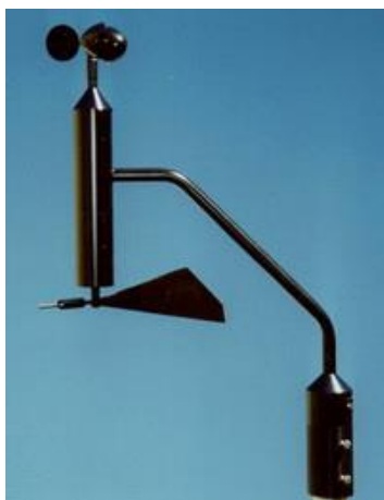
Abbildung 5: Windgeber mit Schalenkreuzanemometer und Windfahne (Kroneis GmbH, 2018)
